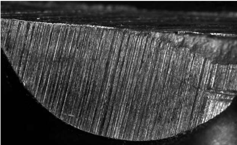
Сліди перекусу дужки навісного замка.
