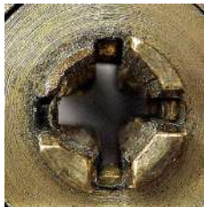
Частини механізмів замків зі слідами впливу сторонніх предметів
