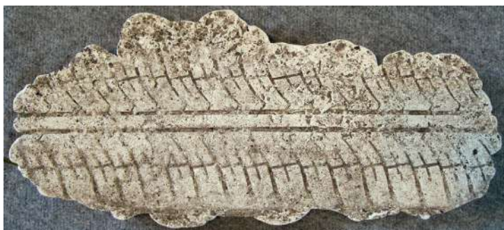
Гіпсові зліпки протекторів шин, якими залишено сліди на місці події
