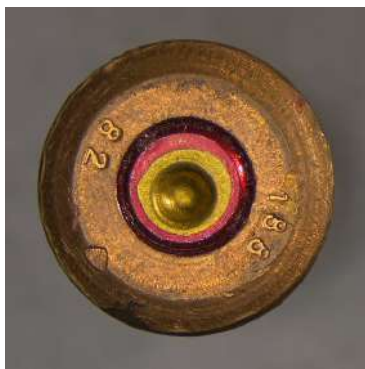
Слід бойка ударника на капсулі гільзи.
