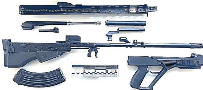
Вогнестрільна зброя компоновки bull-pup (неповне розбирання)
