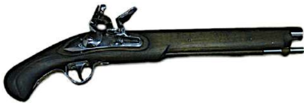
Пістолет з кременінним запальним механізмом.
